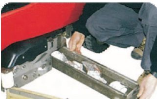
Kehr-Walzenschrubbaggregat mit Grobschmutzsammelbehälter
