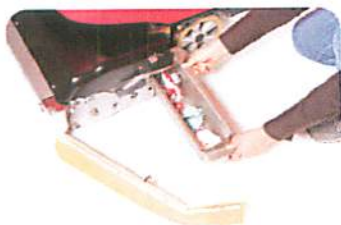
Kehr-Walzenschrubbaggregat mit Grobschmutzsammelbehälter aus Edelstahl
