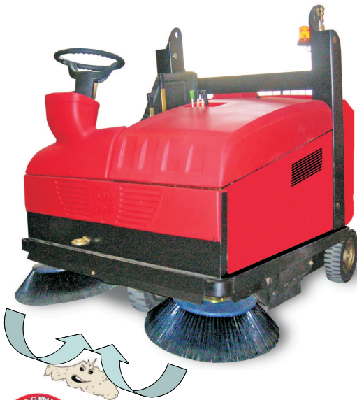
Seitenbesenabsaugung für die staubfreie Reinigung
