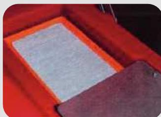
Einfach austauschbarer Filter der Saugmotoren reduziert Wartungskosten.
